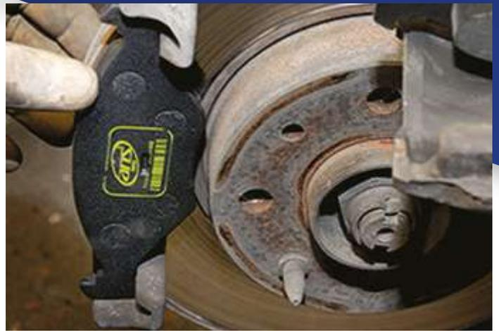
Procedemos a medir el desgaste que a sufrido el disco, verificamos la medida de la pastilla a colocar si encaja o hay que chaflarla en sus lados superior e inferior, para que la superficie en contacto con el disco sea la totalidad de la pastilla de remplazo.
