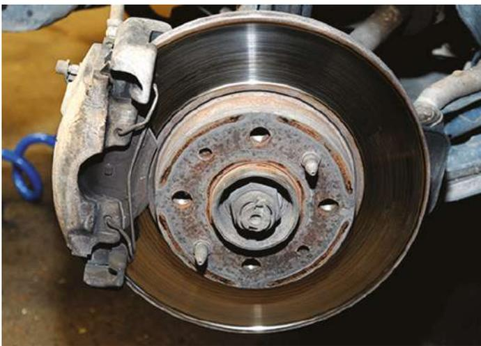
Sacando la rueda vehículo, podemos observar el conjunto de freno. Como se puede apreciar, el disco de freno está muy marcado por el desgaste realizado por la pastilla, dejando un surco en la parte central y una rebarba en las partes externas del mismo.
