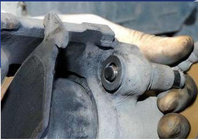
Más marcado que en la imagen anterior, está el desplazamiento de los pernos a los cuales hay que desmontar para proceder a limpiar y lubricar, si fuera necesario por el desgaste hay que cambiarlos por un nuevo conjunto, luego de probarlo en el alojamiento del cáliper, verificar si corresponde un original o un supermedida.
