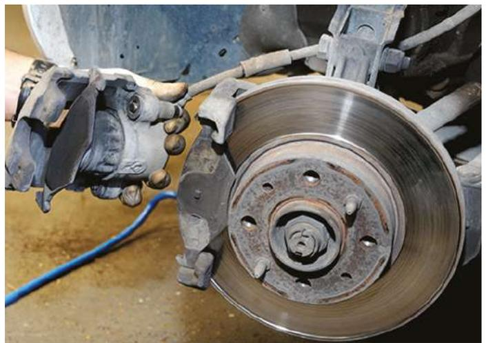
Una vez desacoplado el cáliper del lugar, tendremos a la vista el conjunto de pistón, evidenciando los residuos dejados por el uso. En esta imagen pueden ver el detalle de los pernos deslizantes.
