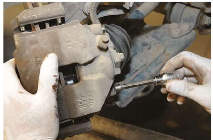
Probamos el deslizamiento suave de los pernos guía, contribuyendo al deslizamiento de la pastilla secundaria al mismo tiempo que la primaria, evitando un retardo a su posición normal y como consecuencia, la elevación de temperatura que provoca la cristalización y posterior chillido.
